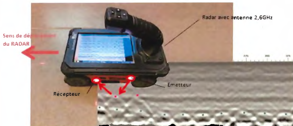
Figure 2 : Principe de l'auscultation RADAR
